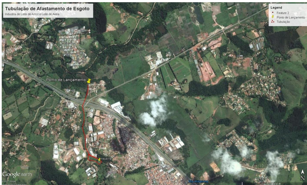
Figura 6 – Tubulação de Afastamento de Esgoto Tratado saindo de Indústria até o Ponto de Lançamento.
